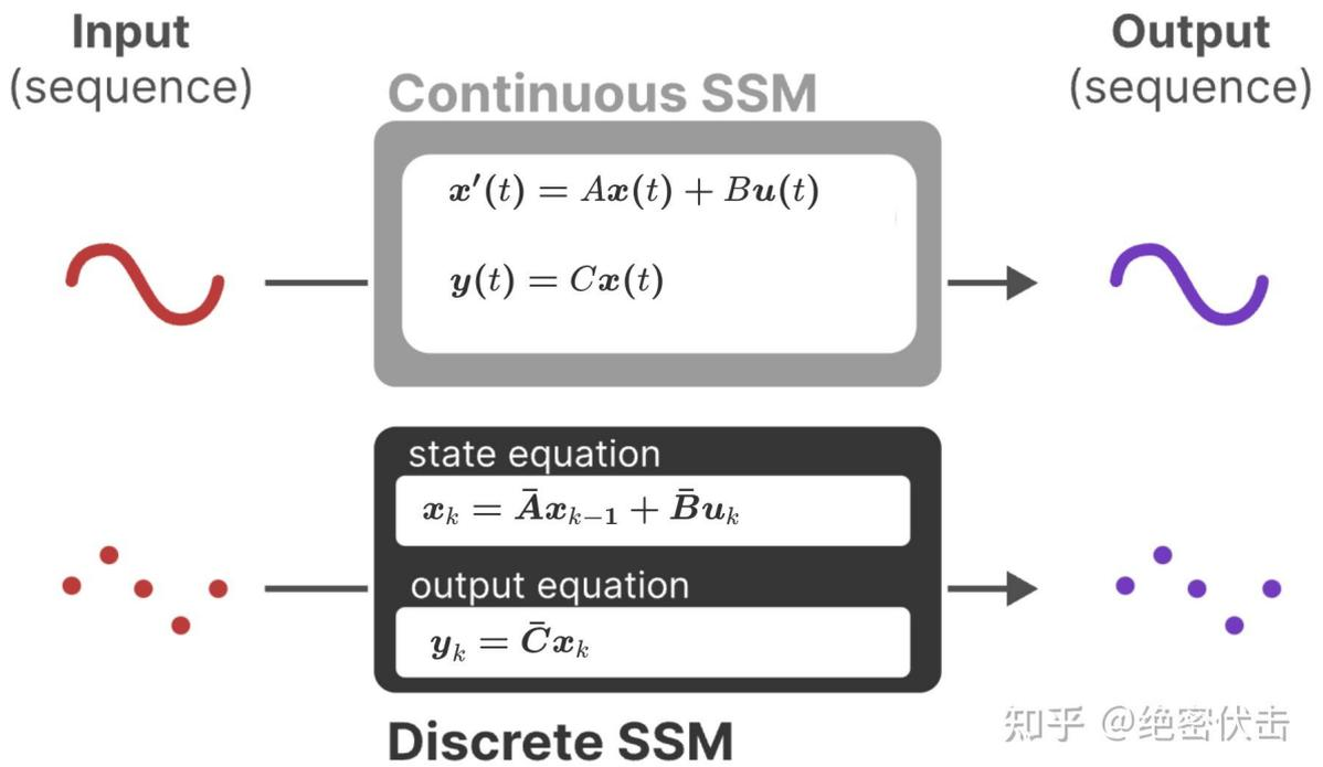
在每个时间步长，我们计算当前输入  $\bar{B}u_k$  如何影响前一个状态  $\bar{A}x_{t-1}$ ，然后计算预测输出  $\bar{C}x_k$ 。
