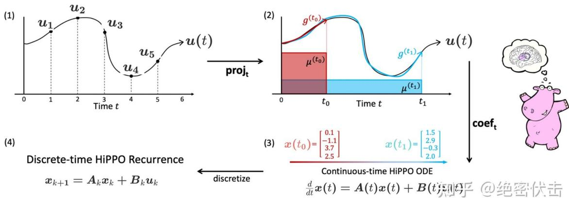
图2-6展示了 HiPPO 框架，首先需要找到投影  $\text{proj}_t$ ，将输入  $u(t)$  投影到多项式空间；然后将投影通过一组系数  $\mathbf{x}(t)$  来表示，这些系数捕捉了函数  $u(t)$  的历史信息；使用连续时间下的一阶常微分方程来表示系数  $\mathbf{x}(t)$  如何随时间  $t$  动态变化；最后，将连续时间的动态变换转化为离散时间的递归关系（比如双线性变换），这允许 HiPPO 在每个时间步  $k$  更新系数  $\mathbf{x}_k$ 。
