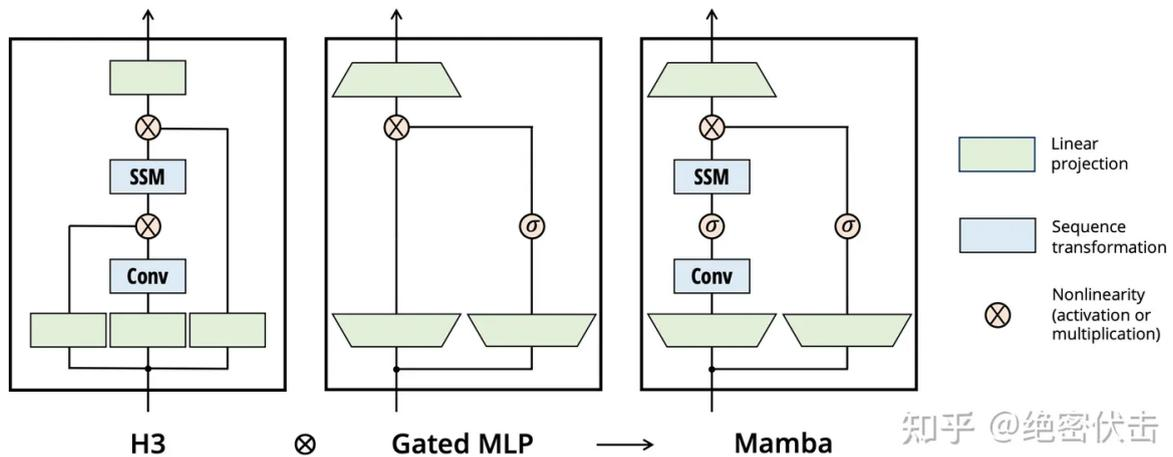
之前的 SSM 模型要 work, 都会加上 output gating, 之后再过个线性层 channel mixing, 如上图的最左边所示。这两个部分跟 Gated MLP (上图中间) 右边的支路和最上面的 channel mixing 是一样的。所以 SSM 层如果跟 Gated MLP 合并的话, 难免会感觉有点冗余, 所以作者干脆把两个合二为一, 把 token mixing 层和 channel mixing.
