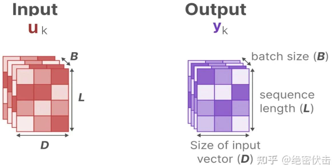
**备注：**在前面的 HiPPO 和 S4 中，我们假设的输入信号  $u(t)$  是 1 维的，而实际应用中大多数都是多维的，后面我们默认是多维输入（默认维度为  $D$ ）。**而且需要强调的是 S4 用的是 Single-input-single-output (SISO)，即对应于每一个输入的维度，都有一套独立的 SSM 参数（传统的 RNN 是 MIMO, multiple-input-multiple-output, 很容易混淆）。**
