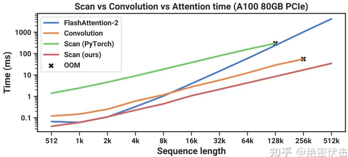
Mamba 的实现比其它方法实现快很多倍, scan 在输入长度 2k 的时候就开始比 FlashAttention 快了, 之后越长越快。同时 scan 也比 Convolution 快。
