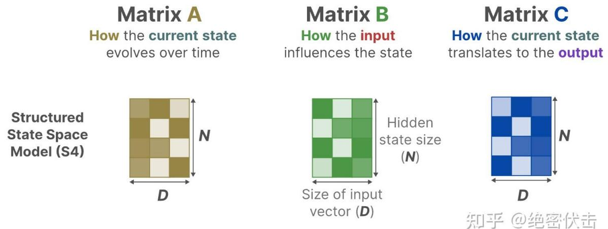
**备注：**实际上矩阵  $A \in \mathbb{R}^{N \times N}$ ，但是通过对角化技术，可以转化为  $N$  维，因此图 5-7 中，每个输入维度对应的矩阵 A 维度为  $N$ ，输入一共是  $D$  维，因此矩阵 A 可以表示为  $N \times D$  的矩阵。
